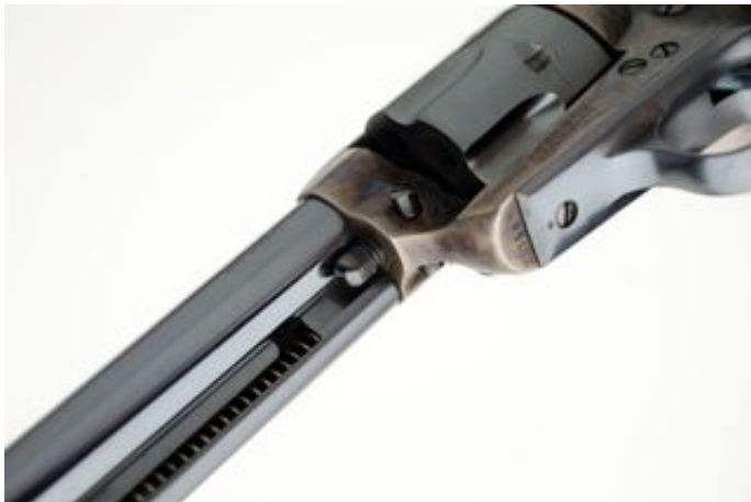
Lorsque Colt mit en service les nouvelles carcasses de Colt single action, adaptées à la poudre sans fumée, il dota ces dernières d'un poussoir permettant de déverrouiller aisément à la main l'axe du barillet.
