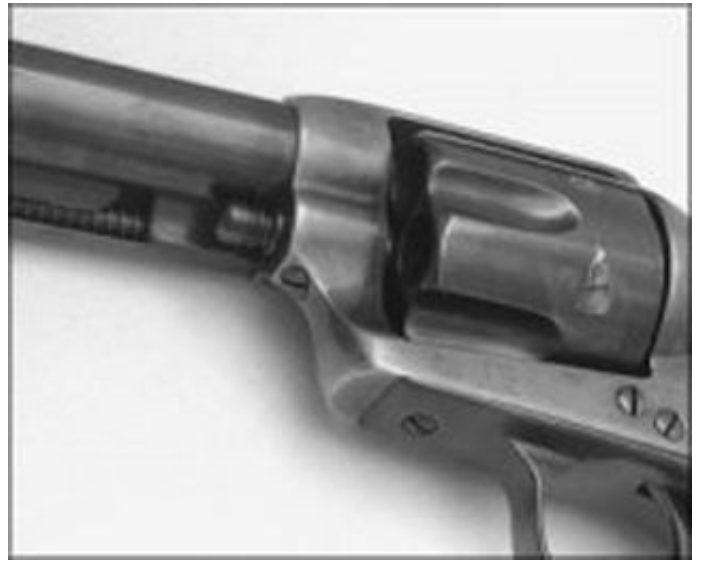
Sur les premiers Colts, prévus pour le tir de cartouches à poudre noire, l'axe de barillet est arrêté par une vis.
